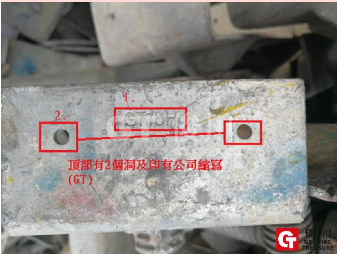
圖 26. 頂部刻有本公司縮寫(圖 26.(1.)), 有 2 個螺絲洞於公司縮寫下方(圖 26.(2.))
