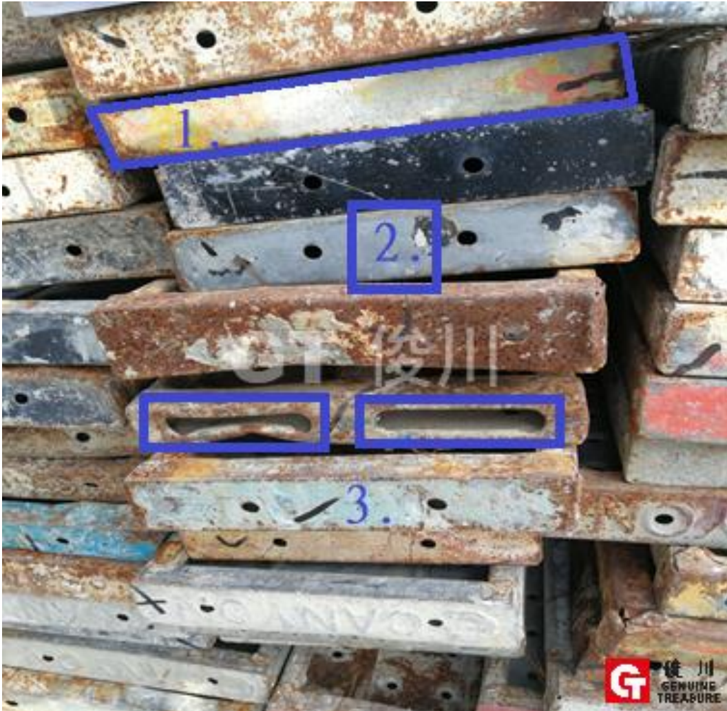
圖 34. 沒有 GT 記號(圖 34.(1.)) (圖 34.(2.)) (圖 34.(3.)) 沒有螺絲洞於板的兩邊(舊板)(圖 34.(1.)) (圖 34.(3.))
