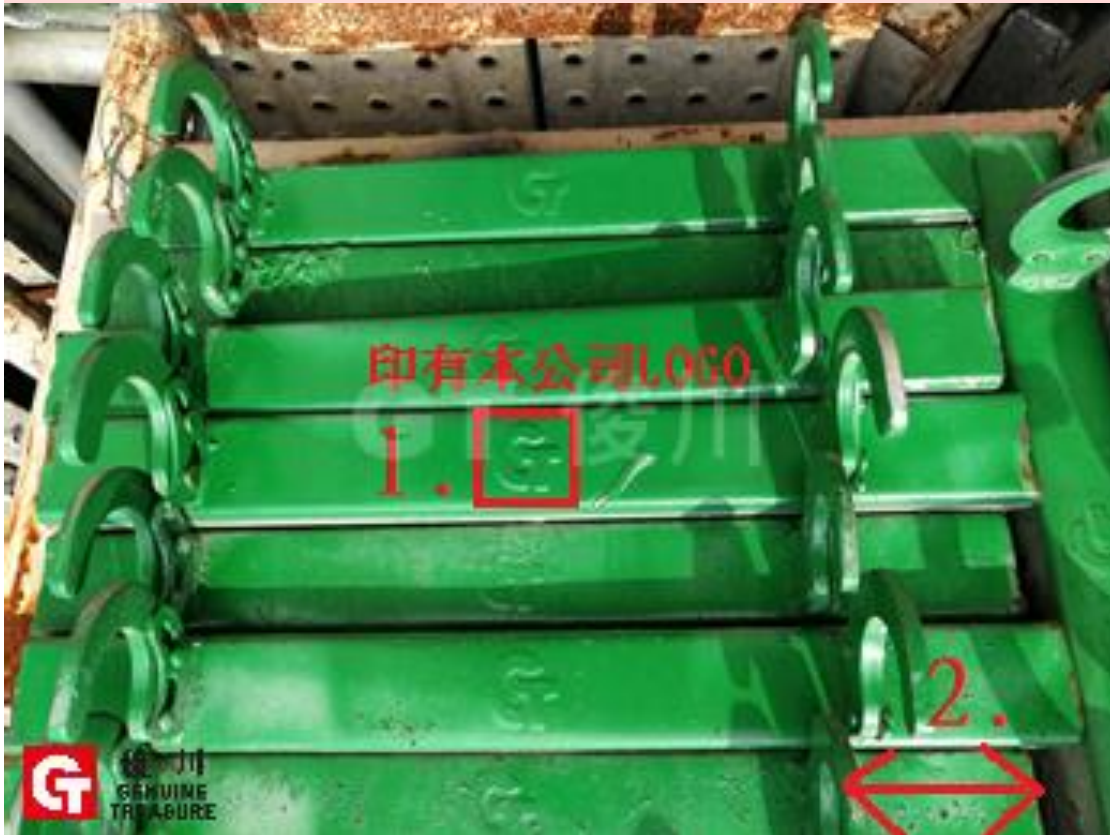
圖 16. 鈎與鈎之間的位置有 GT 記號(圖 16.(1.)), 鈎與板邊有一定距離(約一個拳頭距離) (圖 16.(2.))
