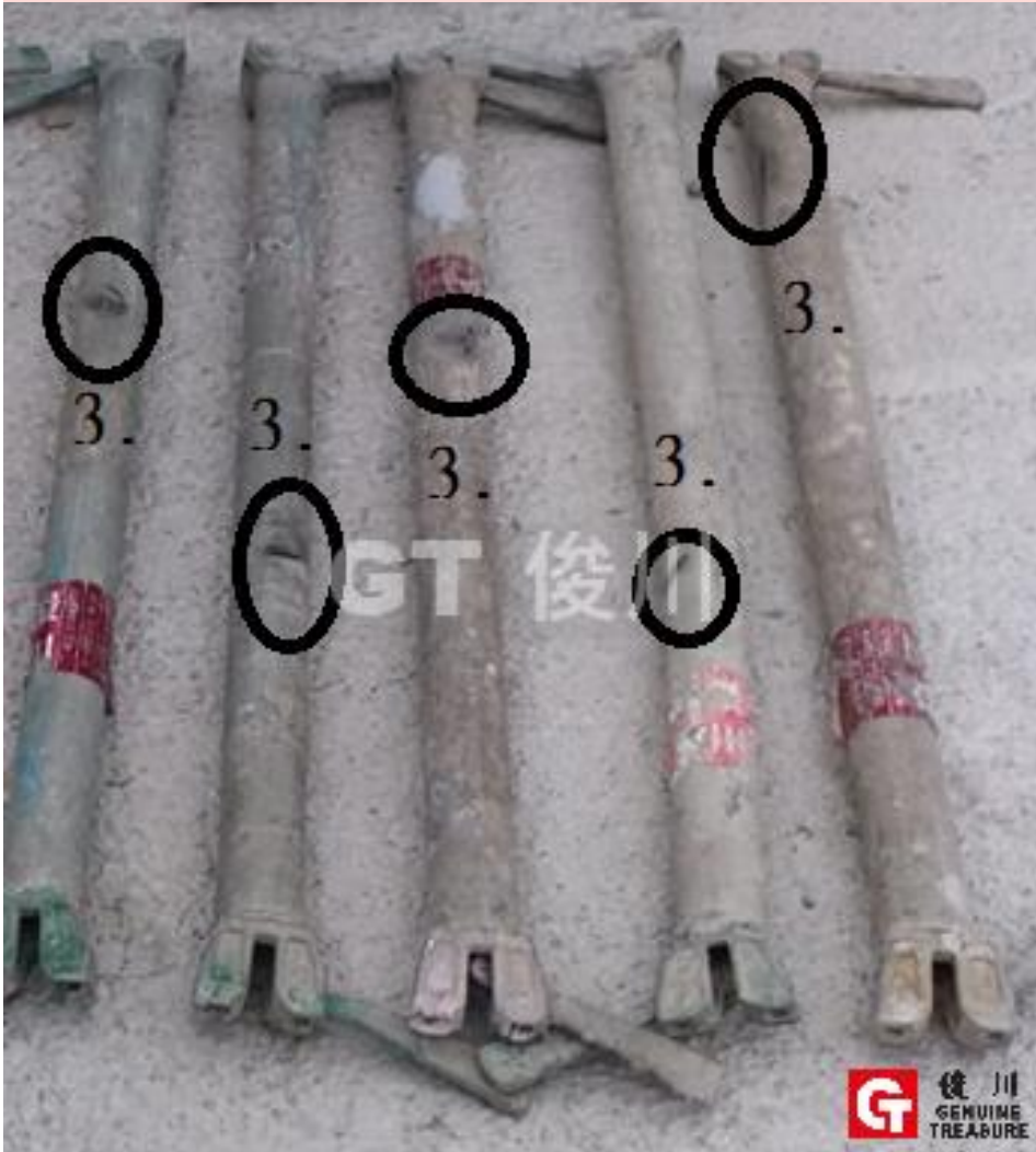
圖 61. 杆身有凹陷破損 (圖 61.(3.))
