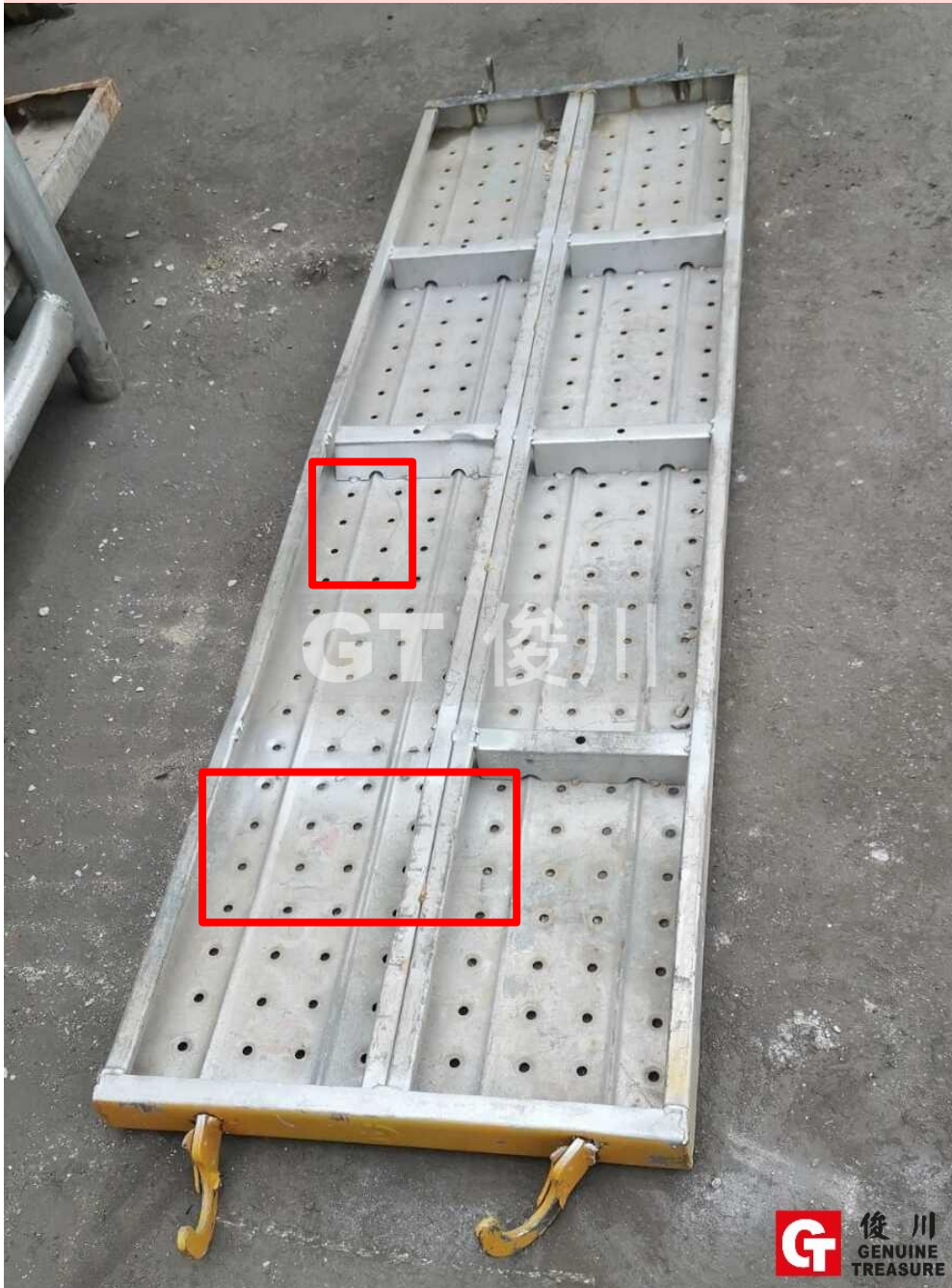
圖 72. 底部支撐斷裂或焊位爆裂
