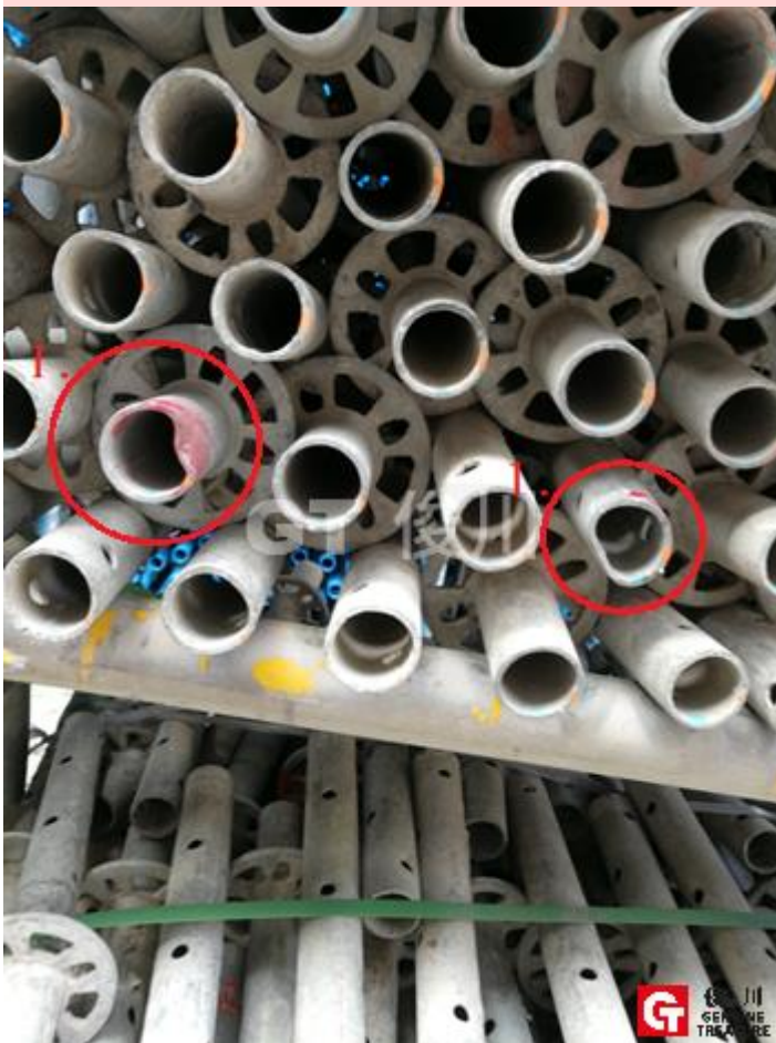
圖 52. 杆頭 / 杆腳尾部輕微凹陷 (圖 52.(1.))
